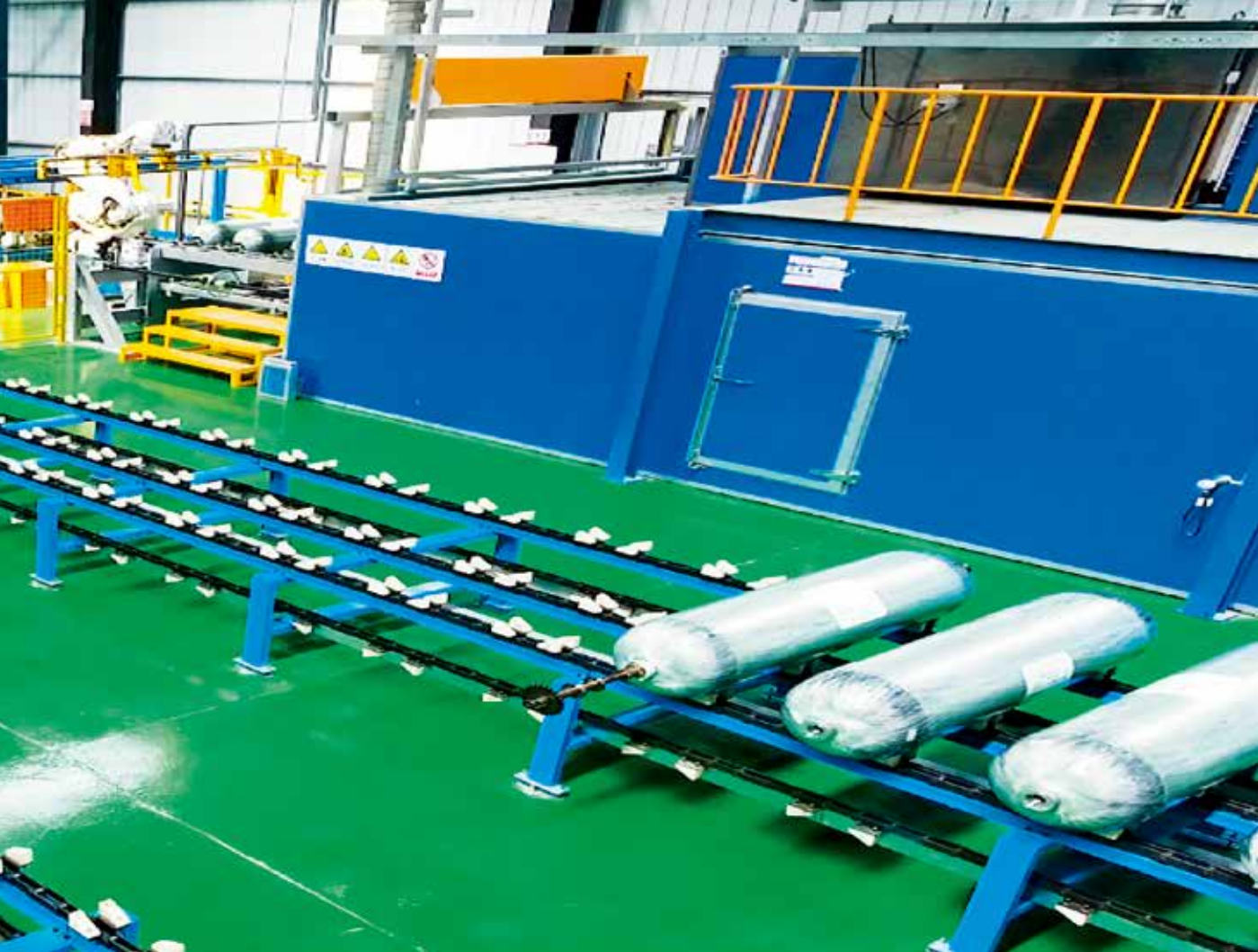
中材科技(成都)1#车间5跨缠绕产线生产165L氢气瓶用于4.5吨厢货、冷链物流车
