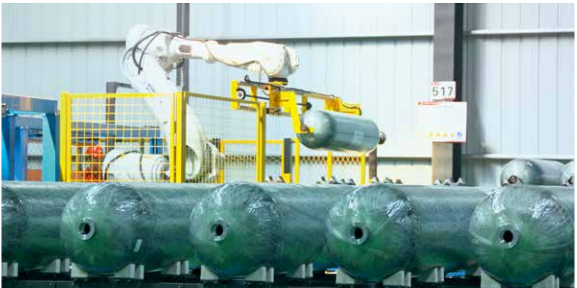
中材科技(成都)1#车间5跨缠绕产线固化出炉165L氢气瓶产品用于4.5吨厢货、冷链物流车
