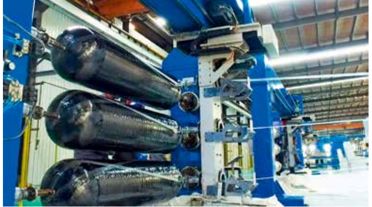
中材科技(成都)1#车间5跨缠绕产线生产165L氢气瓶用于4.5吨厢货、冷链物流车
